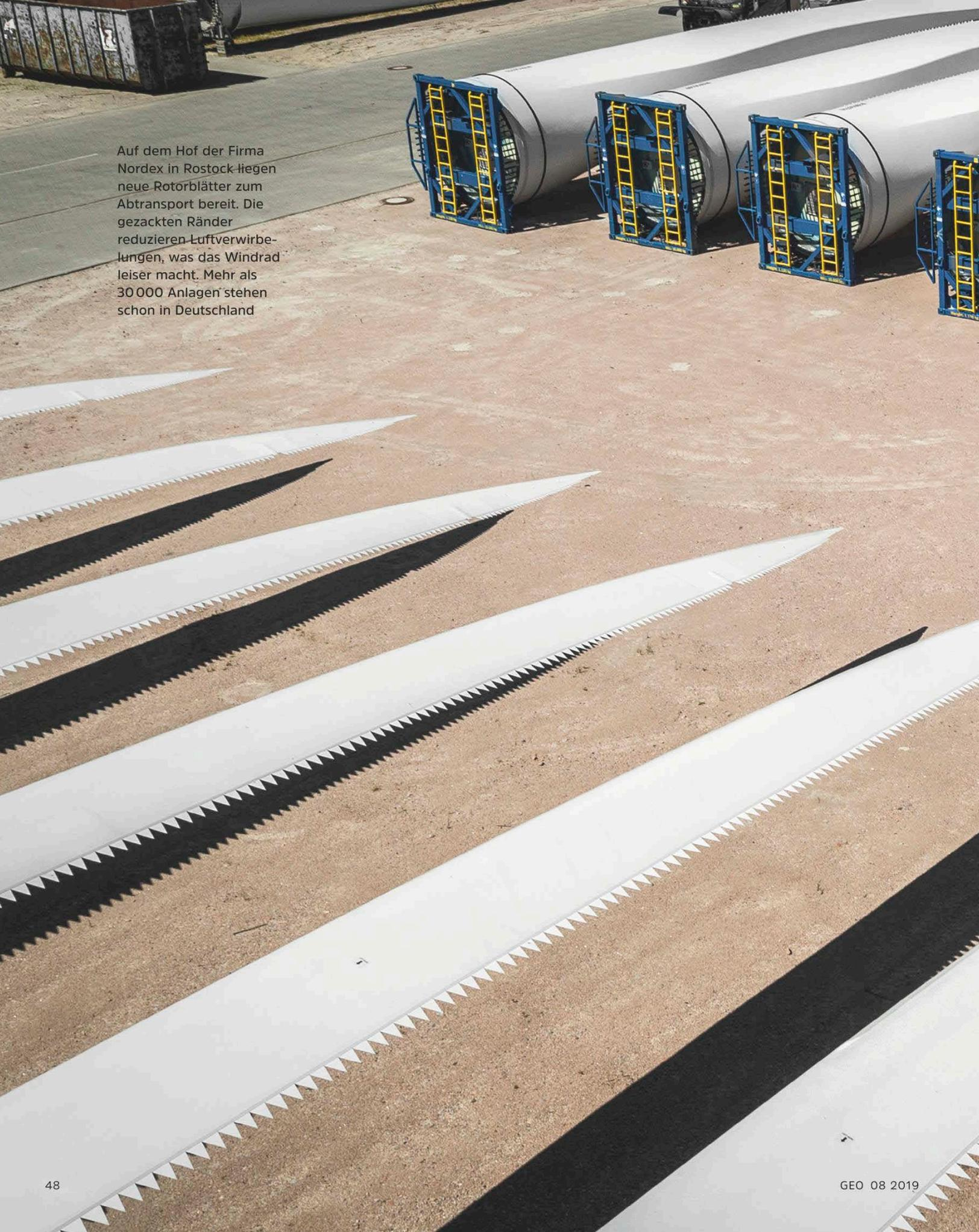
Auf dem Hof der Firma Nordex in Rostock liegen neue Rotorblätter zum Abtransport bereit. Die gezackten Ränder reduzieren Luftverwirbelungen, was das Windrad leiser macht. Mehr als 30 000 Anlagen stehen schon in Deutschland
